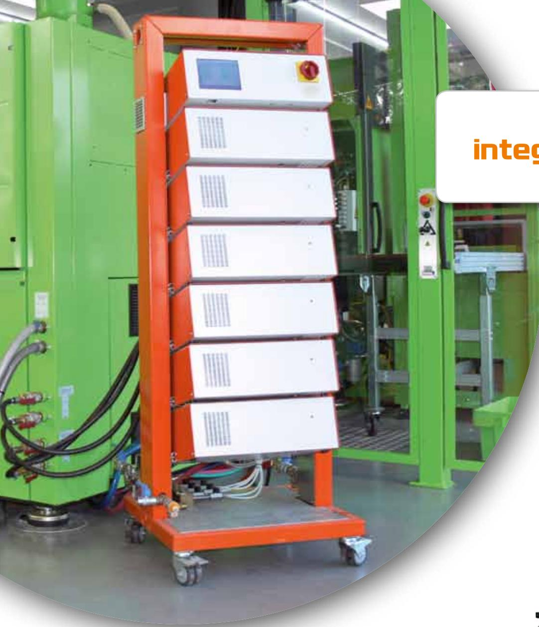
Le gwk integrat 40 est un système de thermorégulation modulaire à circuit multiple intégrable dans l'ensemble du processus pour la thermorégulation segmentée d'outil.
