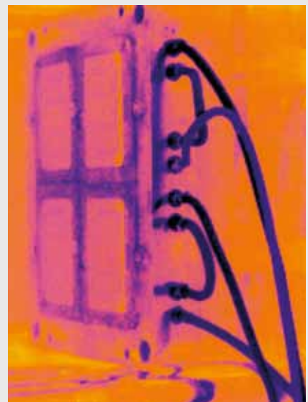
Répartition homogène de la température dans l'outillage après nettoyage des circuits de refroidissement.
