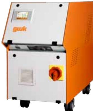
Le thermorégulateur **gwk** de la série **teco cs 230t 9** est un appareil de chauffage et de refroidissement prêt au raccordement, avec refroidissement indirect, conçu pour un fonctionnement avec de l'eau comme fluide de circulation. Le circuit d'eau conçu comme un système fermé avec surpression automatique permet une utilisation sûre jusqu'à 225 °C.
