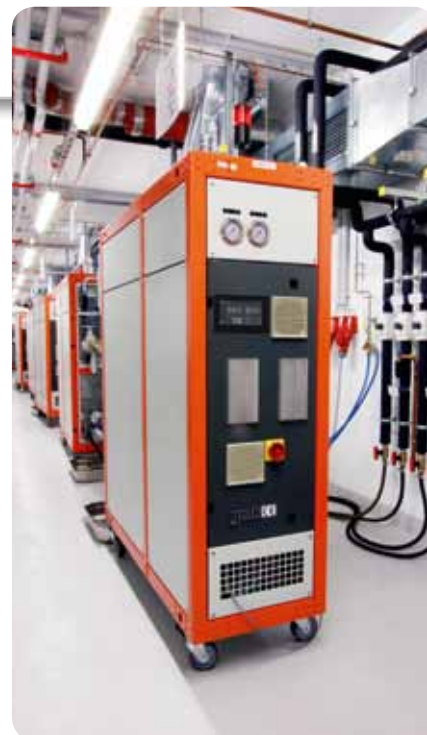
Les thermorégulateurs des séries teco tt et teco th répondent aux exigences spéciales des températures de fonctionnement allant jusqu'à 300 et 350 °C.
